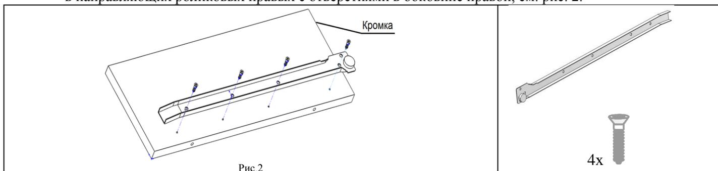
4.1.3. К сборкам по п.4.1.1. и п.4.1.2. прикрутить с помощью винтов конфирмат (поз.3, пакет № 96) плиту нижнюю (поз.3), см. рис.3.
