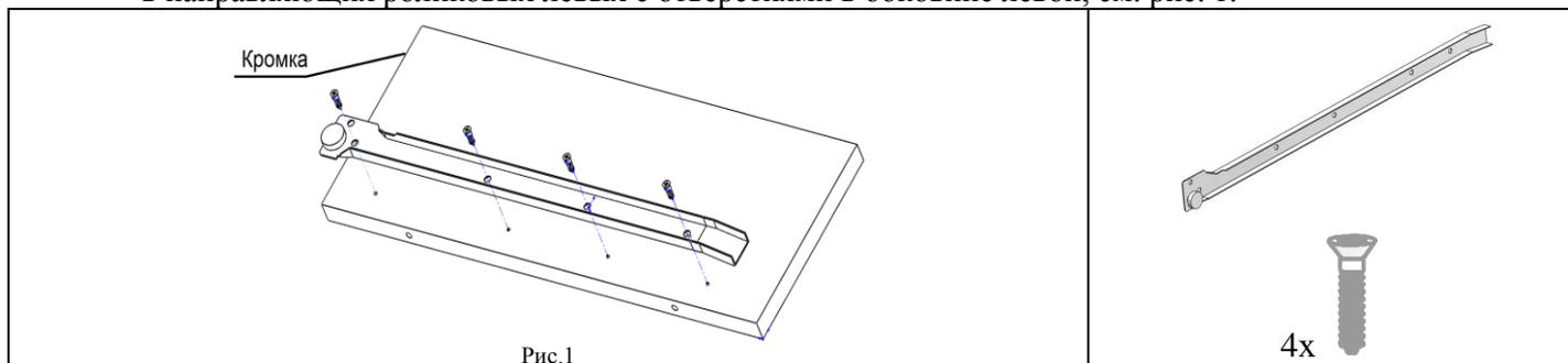
4.1.2. К боковине правой (поз. 2) прикрутить направляющие роликовые правые L=400 (наружные) (поз.1, пакет № 94) при помощи евровинтов ЕС4,0x13 (поз.1, пакет №96), предварительно совместив отверстия в направляющих роликовых правых с отверстиями в боковине правой, см. рис. 2.
