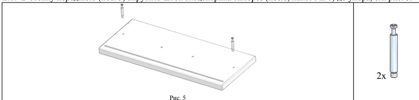
4.2.2. На сборку по п. 4.2.1. установить стенки боковые ящика (поз. 7) (см. рис. 6). В отверстия боковин вставить эксцентрики 311-80 (поз. 9, пакет №96) стрелкой в направлении стенки передней и повернуть эксцентрик по часовой стрелке 180° max., см. рис. 6а, 6б.
