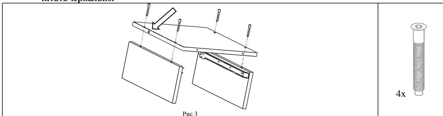
4.1.4. К сборке по п. 4.1.3. прикрутить с помощью винтов конфирмат (поз. 3, пакет № 96а) плиту верхнюю (поз.4). На винты конфирмат поверх установить СУТ.11.006.Заглушки конфирмат (поз.4, пакет №96), см. рис.4.
